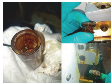
Encrassement et dépôt de vernis dans l'huile.
