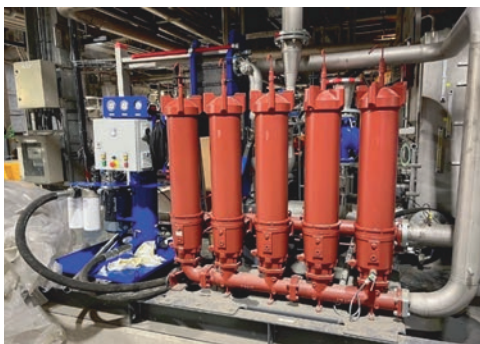
Mise en propreté d'huile hydraulique d'une presse à sabot fournie par Valmet.
