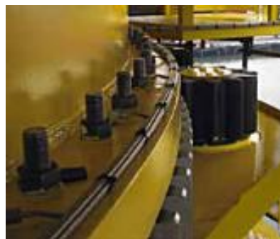
Lubrification des pignons d'entraînement et de dentures de couronnes
