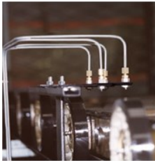
Lubrification par micro-lubrification
