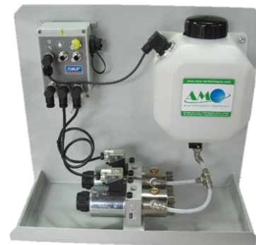
Platine de lubrification de chaînes par projection d'huiles
