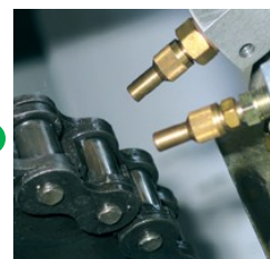
3 Lubrification par micro-lubrification
