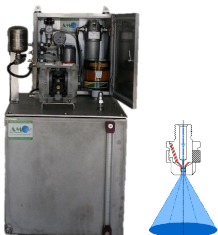
2 Coffret de micro-pulvérisation d'huile sur chaînes avec système Air/Huile
