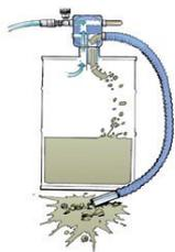
Pompe à vide pneumatique adaptée pour l'aspiration des huiles usées ou des fluides contenant des particules abrasives (exemple : copeaux métalliques dans les huiles de coupe).
