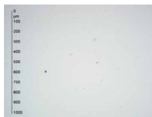
Classe 15/13/10 (ISO 4406) Classe 4 (NAS 1638) Grossissement : x 100 1 graduation = 10 µm
