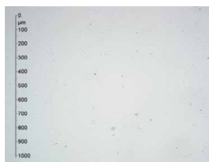
Classe 17/15/12 (ISO 4406) Classe 6 (NAS 1638) Grossissement : x 100 1 graduation = 10 µm
