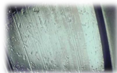
Indentations sur les pistes d'un roulement causées par une pollution particulaire
