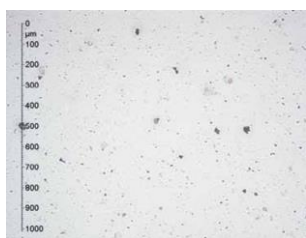
Classe 20/18/15 (ISO 4406) Classe 9 (NAS 1638) Grossissement : x 100 1 graduation = 10 µm
