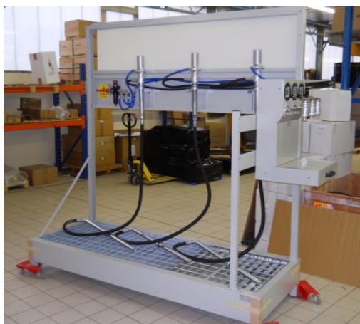
Portique de distribution des huiles
