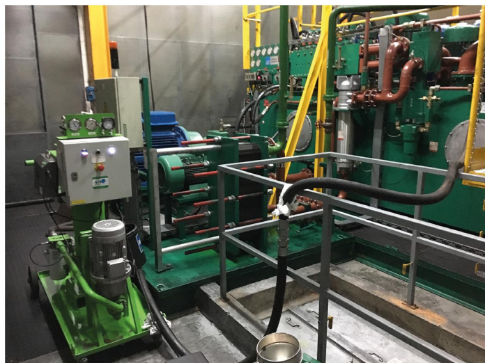
Dépollution d'une charge de 5m 3 dans une centrale hydraulique de laminoir, après un test MPC (verniss et précurseur de verniss) trop élevé. Passage de 33 à 10 après 2 mois de traitement avec filtre 0,9µ.
