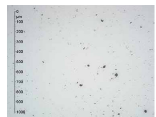
ISO 4406 Classe 19/17/14 NAS 1638 Classe 8 Grossissement : x 100 1 graduation = 10 μm
