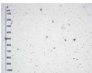
ISO 4406 Classe 20/18/15 NAS 1638 Classe 9 Grossissement : x 100 1 graduation = 10 μm
