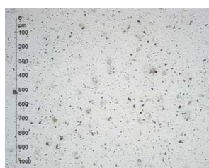
ISO 4406 Classe 22/20/17 NAS 1638 Classe 11 Grossissement : x 100 1 graduation = 10 μm
