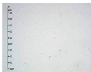
ISO 4406 Classe 17/15/12 NAS 1638 Classe 6 Grossissement : x 100 1 graduation = 10 μm
