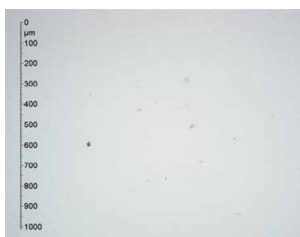
ISO 4406 Classe 15/13/10 NAS 1638 Classe 4 Grossissement : x 100 1 graduation = 10 μm
