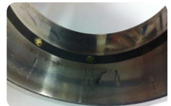
Corrosion à l'arrêt
