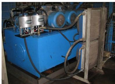
**Système de filtration pour une installation à demeure sur les équipements, filtre en by-pass comprenant plusieurs corps SDU.**
