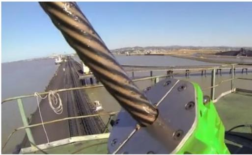
Le graissage des câbles permet d'augmenter la durée de service des câbles de 30% à 50% selon les conditions d'utilisation.
