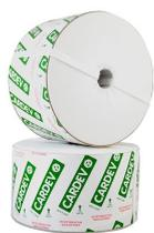
L'élément filtrant AMO-SDFCU CARDEV est fabriqué à partir de longues fibres de cellulose, il est équipé avec un disque de protection en polyester sur le diamètre entier. Il peut être utilisé sur tous les fluides à base d'huile tels que l'hydraulique, moteur, boîtes de vitesses, engrenages et les carburants diesel.
