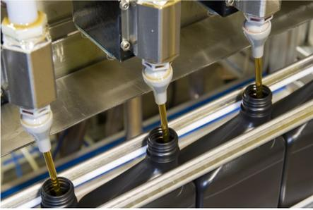
**Unité de dosage de graisse ou d'huile pour des applications diverses sur les lignes de montage et d'assemblage industrielles.**
