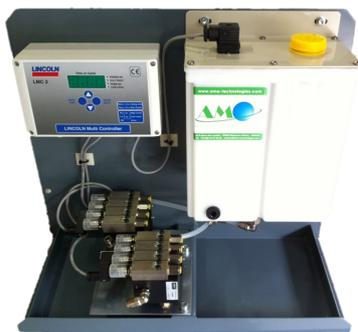
Platine de lubrification de chaînes par micro-lubrification
