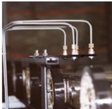
Lubrification des 4 points avec buses simples
