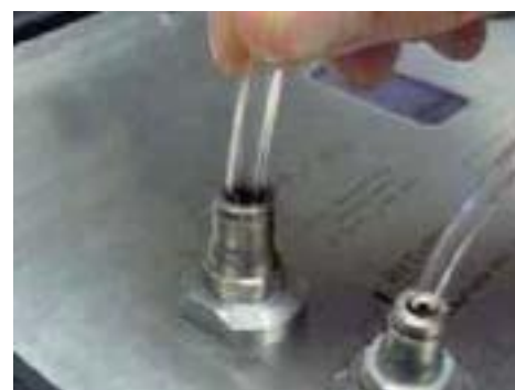
Raccordez le tuyau souple ENTRÉE (Ø 6 mm)
