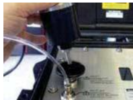
Connexion manuelle : enfoncez fermement le réducteur de pression dans l'orifice ENTRÉE
